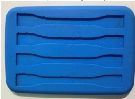
Figura 24 - Molde para os corpos de prova de tração.
