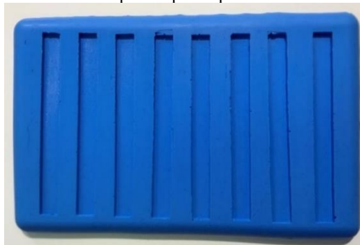
Figura 25 - Molde dos corpos de prova para o ensaio de flamabilidade.
