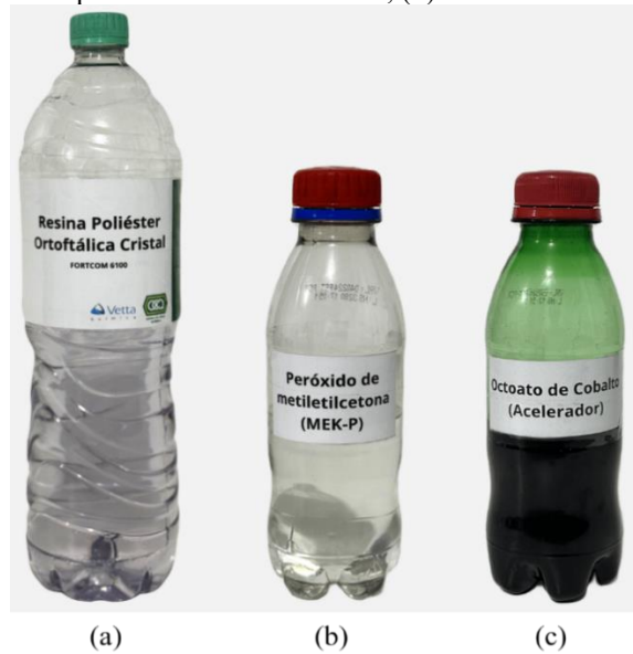
Figura 19 - Materiais: (a) resina poliéster ortoftálica cristal; (b) iniciador MEK-P e (c) acelerador de cobalto.
