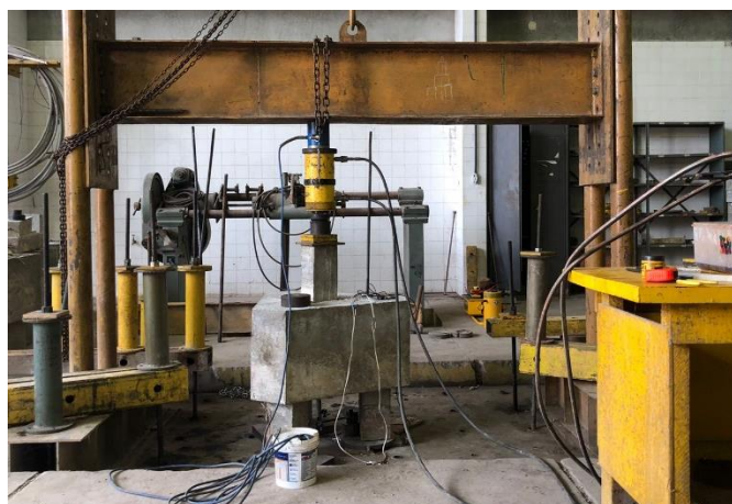
Figura 8. Sistema de reação para ensaio dos blocos.
