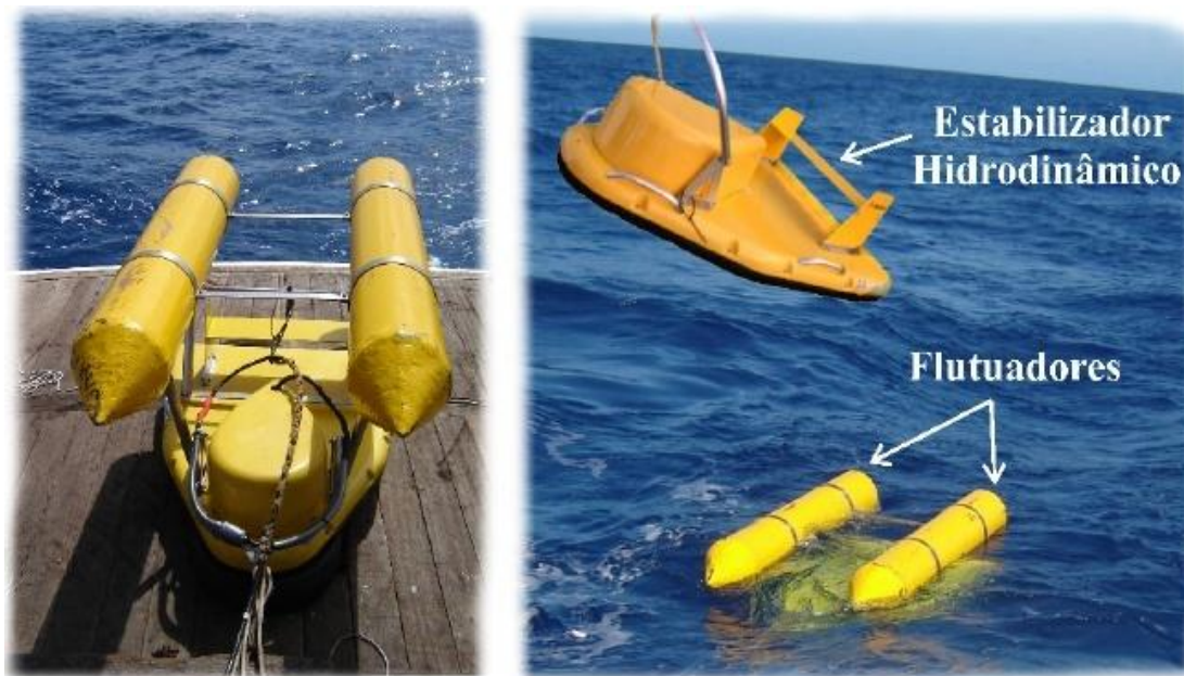
Figura 5: Perfilador de subsuperfície e superfície do tipo chirp modelo SB-512i (X-Star). Fonte: Empresa Edgetech.
