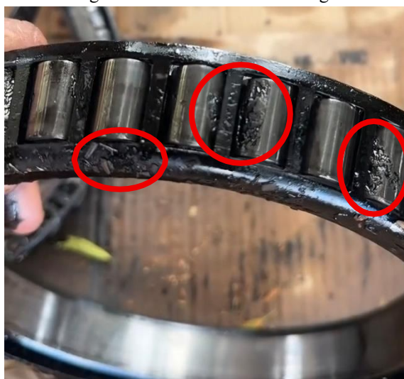
Figura 9 - Rolamento cônico desgastado
