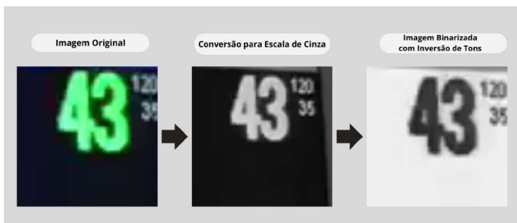
Figura 8 – Fluxo de Pré-Processamento: Conversão para Escala de Cinza e Binarização
