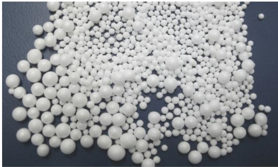
Fig. 57 - Bolhas de EPS. O material é composto de 98% de ar e 2% de EPS. Acessado em 08/06/2018. Fonte: http://www.epsbrasil.eco.br/eps/index.html
