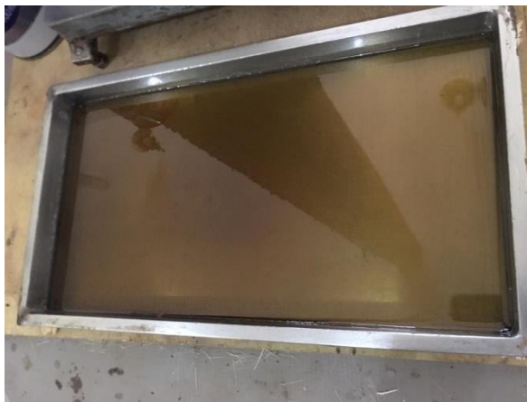
Figura 12 – Mistura de resina, acelerador, argila e iniciador disposta no molde nivelado.
