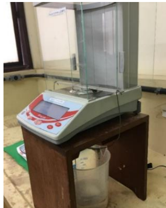
Figura 17 - Aparato para medição da massa imersa do material.
