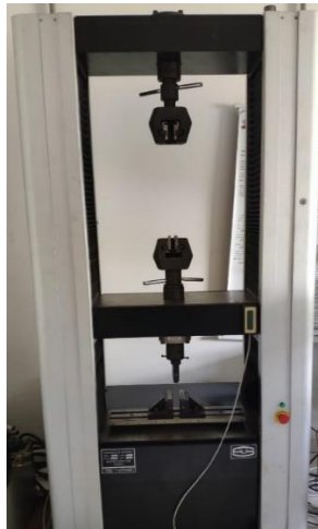
Figura 18 – Máquina universal para realização dos ensaios mecânicos (tração e flexão).
