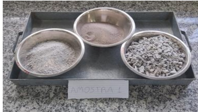
Figura 18 - Amostra 1: brita 0, pó de pedra e areia natural.
