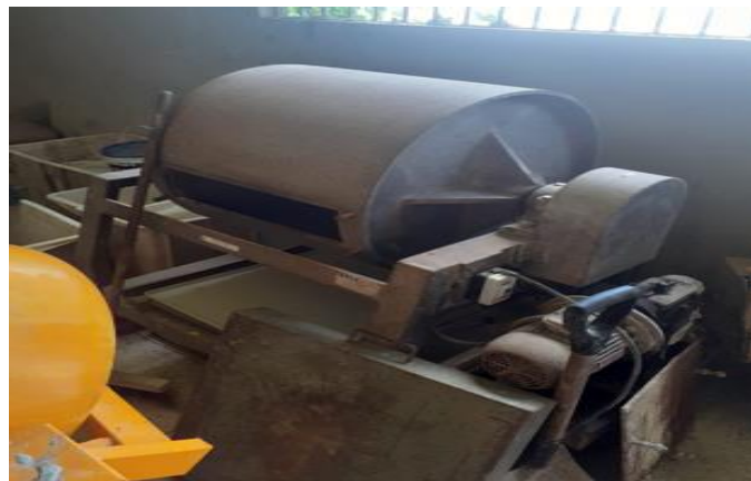
Figura 20 - Máquina de abrasão “Los Angeles”.
