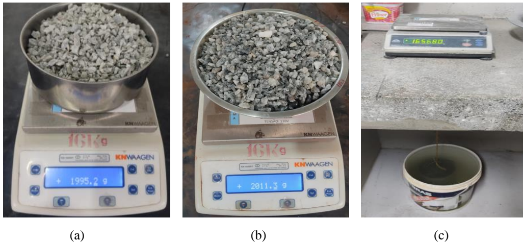
Figura 22 - Determinação dos pesos: (a) seco; (b) saturada superfície seca; (c) submerso.
