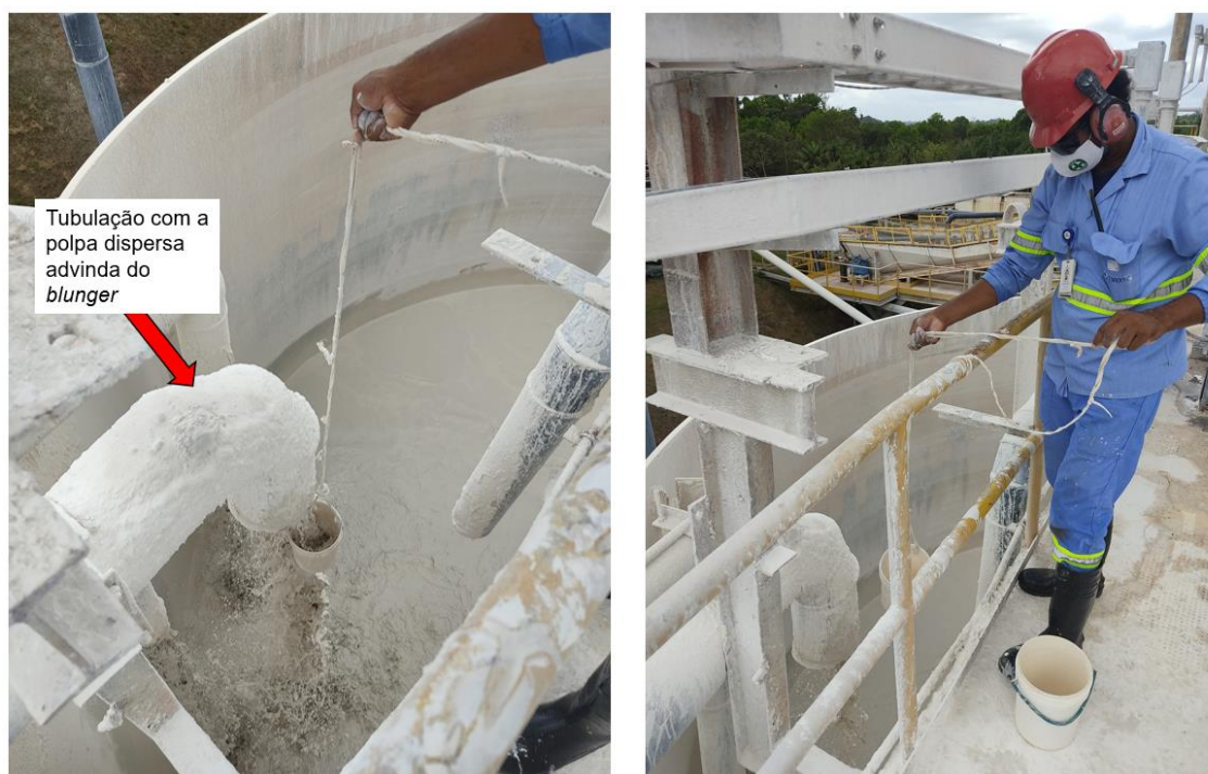
Figura 25 - Operador realizando a cada 2h a coleta do material que foi alimentado e disperso no blunger .
