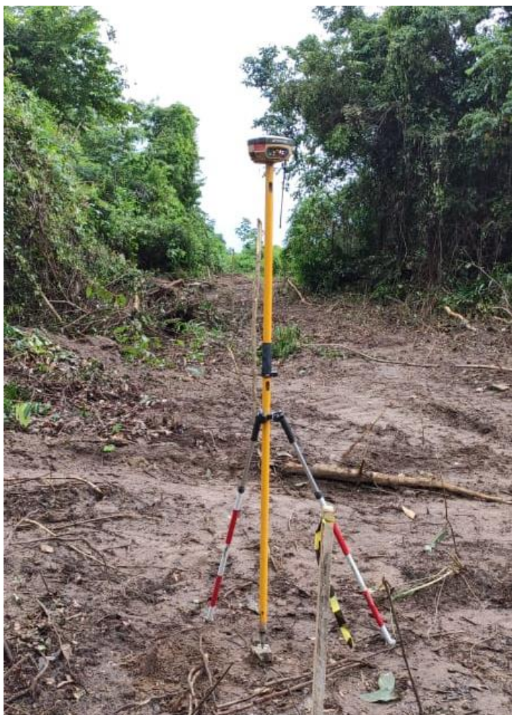
Figura 28 - Bastão utilizado em campo para o cadastro das coordenadas topográficas X, Y, Z.
