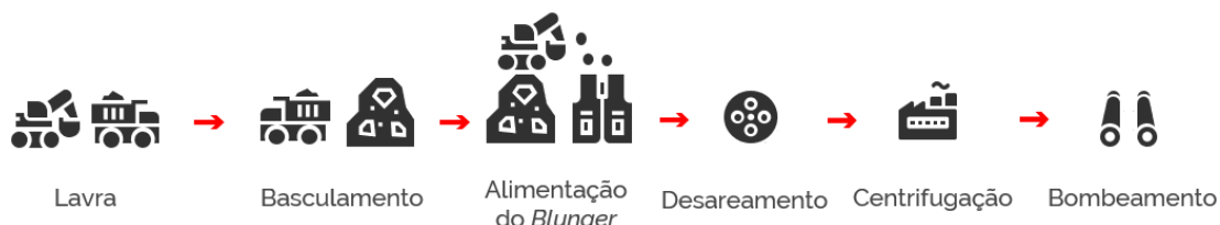
Figura 11 - Fluxograma demonstrado a etapa de lavra até o bombeamento do minério.
