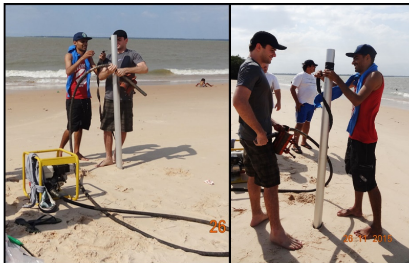
Figura 15 - Coleta da sequência sedimentar vertical com o amostrador à vibração (vibracorer).
