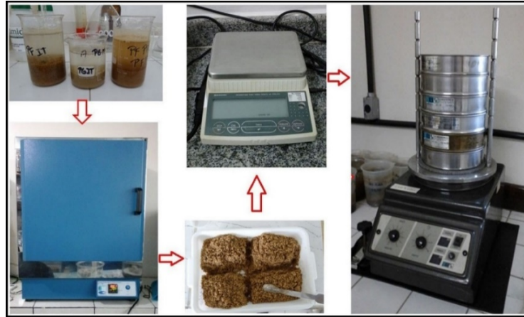
Figura 20 - Procedimentos metodológicos para análise granulométrica: A - lavagem das amostras; B - secagem em estufa; C - quarteamento da amostra; D - pesagem; E - separação granulométrica via peneiramento.
