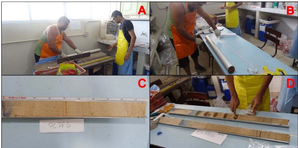
Figura 19 – Abertura dos testemunhos: A – corte do tubo com serra elétrica; B – corte longitudinal com corda de violão; C – descrição visual do pacote sedimentar; D – retirada de amostras em diferentes intervalos.
