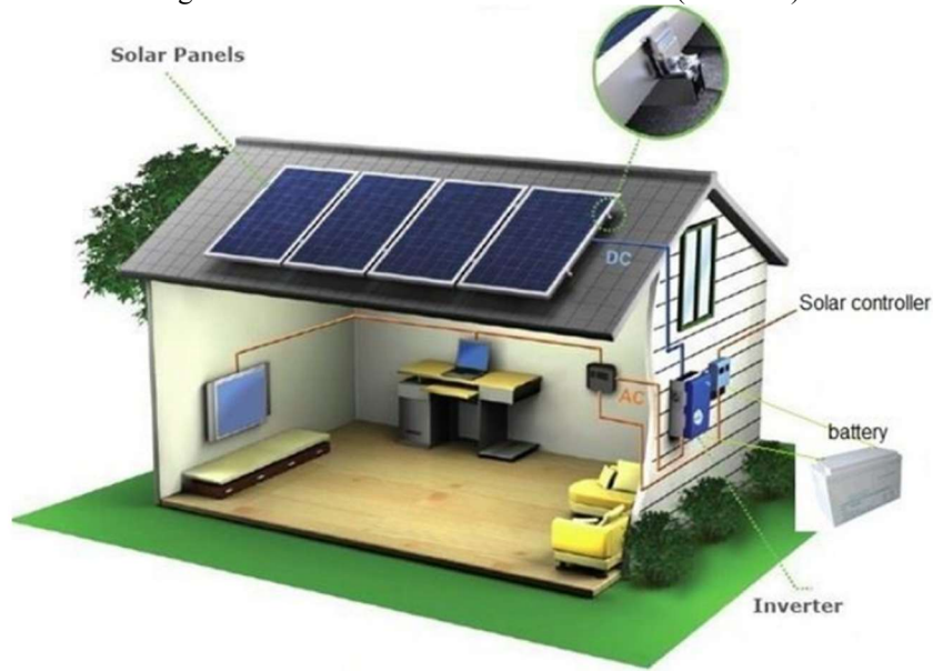
Figura 10 – Sistema fotovoltaico autônomo (Off-Grid)
