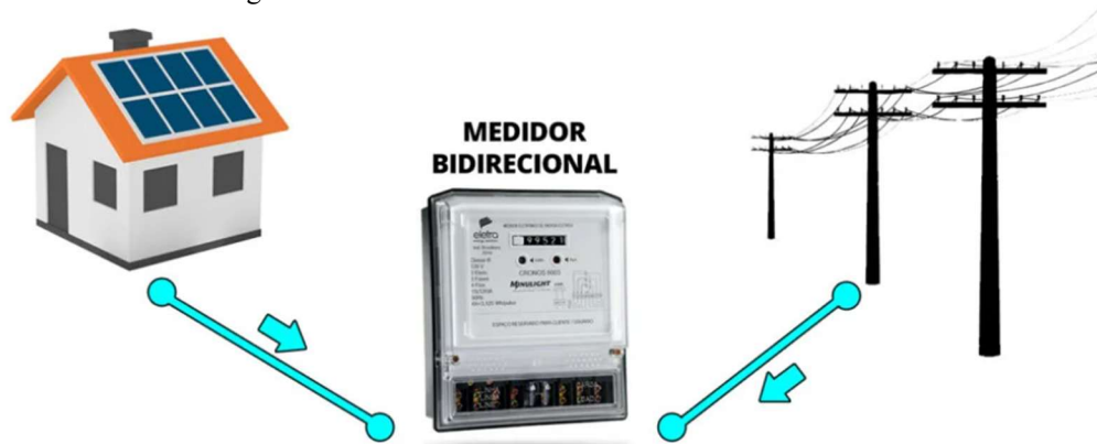
Figura 26 – Funcionamento de um medidor bidirecional
