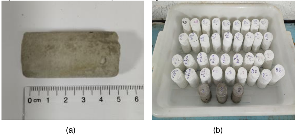
Figura 22 - Materiais para o teste absorção de água por capilaridade: a) corpo de prova cilíndrico e b) Corpos de prova submetidos à imersão parcial em água.
