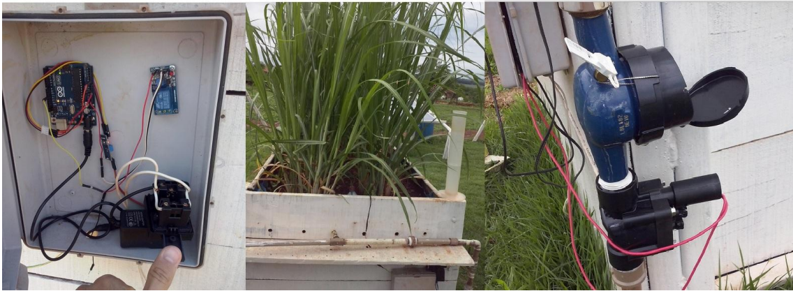
Figura 13-Esquema de ligação do sistema de automação no lisímetro de drenagem e na Válvula solenoide. Fonte: Cardoso, Sá, Silva, Camargo, 2015
