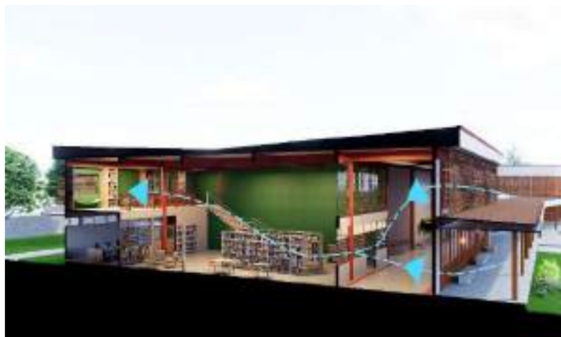
Figura 40 — Corte em perspectiva Ventilação cruzada e Iluminação pelos Muxarabis e Cobogó
