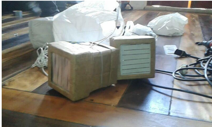
Foto. 14 - refletores laterais com recorte das grades na chapa off Set .
