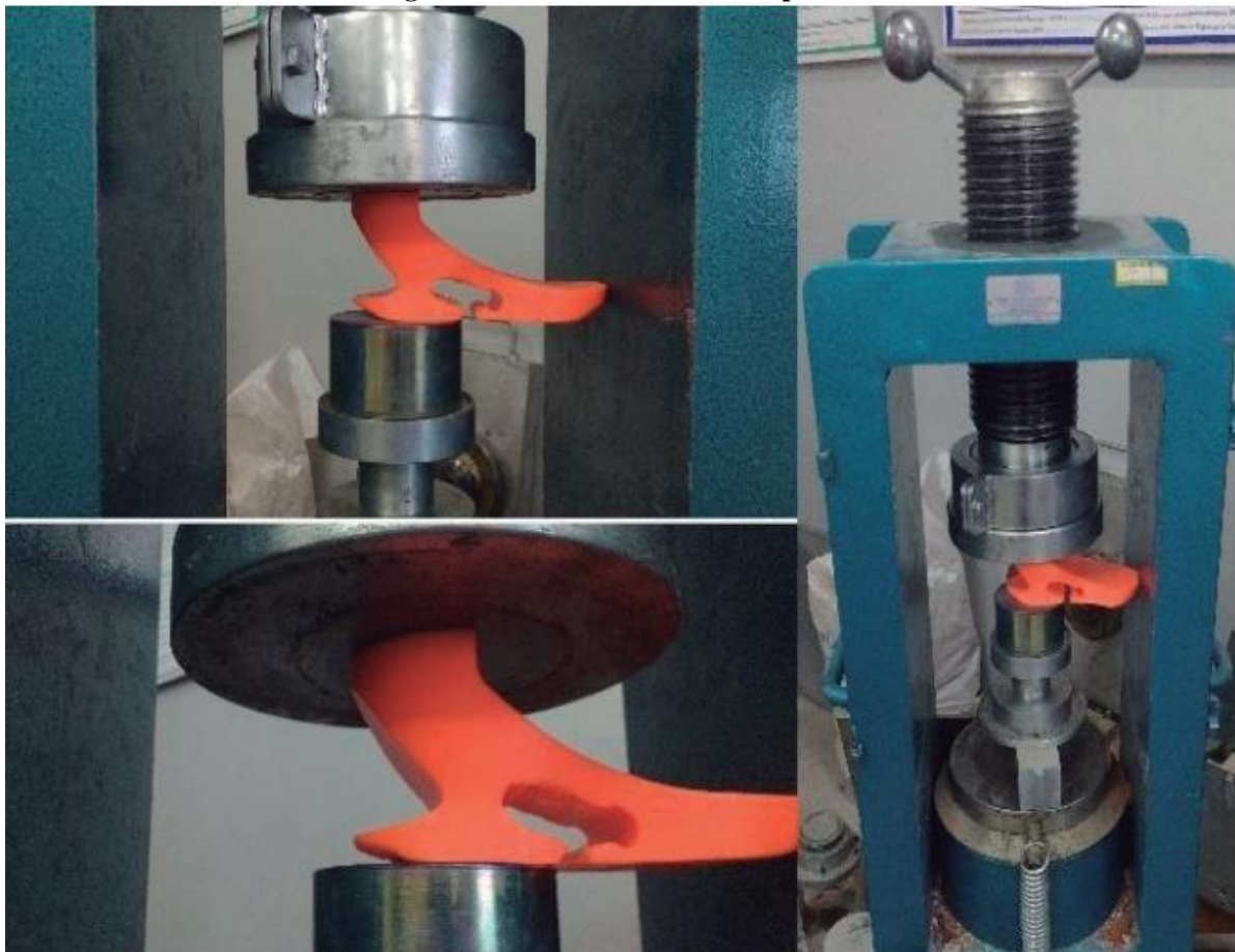
Figura 8. Ensaio mecânico de compressão
