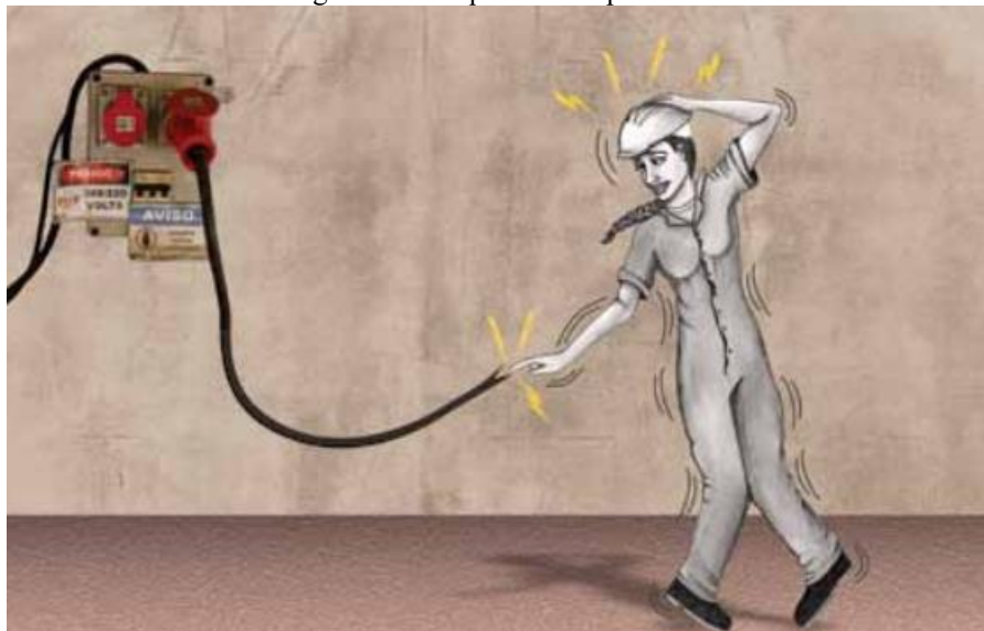
Figura 3 - Choque elétrico por contato direto
