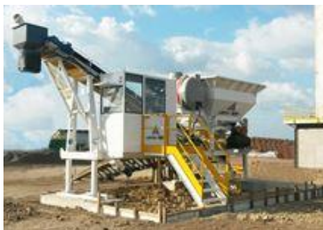
Figura 3 – Central dosadora de concreto - Usina Semimóvel
