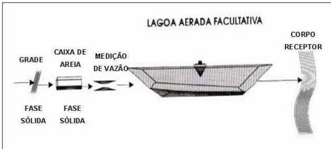
Figura 2- Esquema de lagoa facultativa aerada
