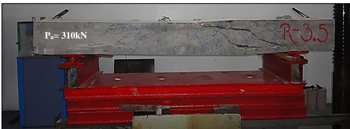
Figura 4.8 - Mapa da fissuração da viga R-3.5
