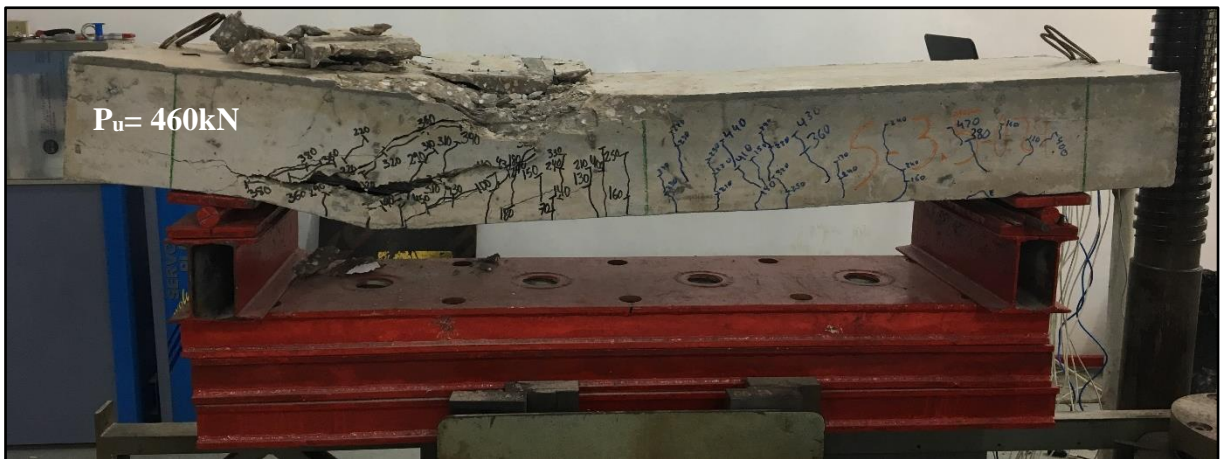
Figura 4.10 - Mapa de fissuração da viga S-3.5-0.24
