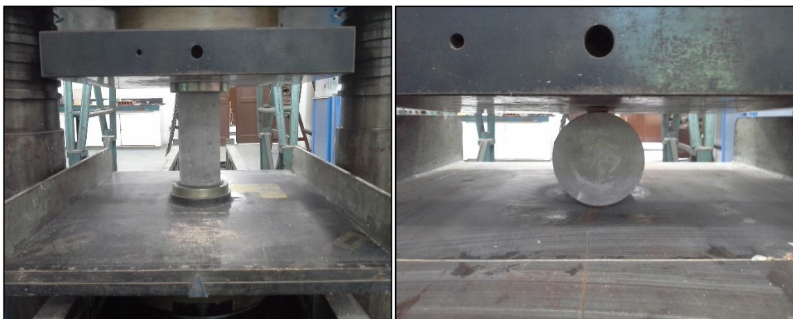
Figura 3.31 - Ensaio de compressão e tração por compressão diametral
