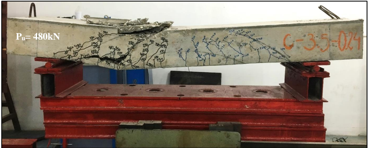
Figura 4.9 - Mapa da fissuração da viga C-3.5-0.24
