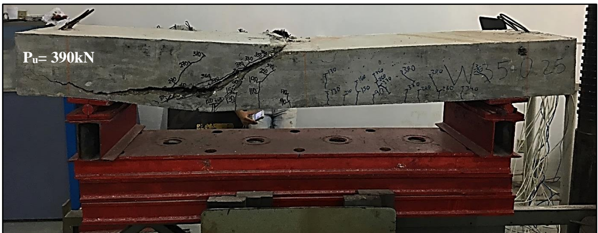
Figura 4.11 - Mapa de fissuração da viga W-3.5-0.25
