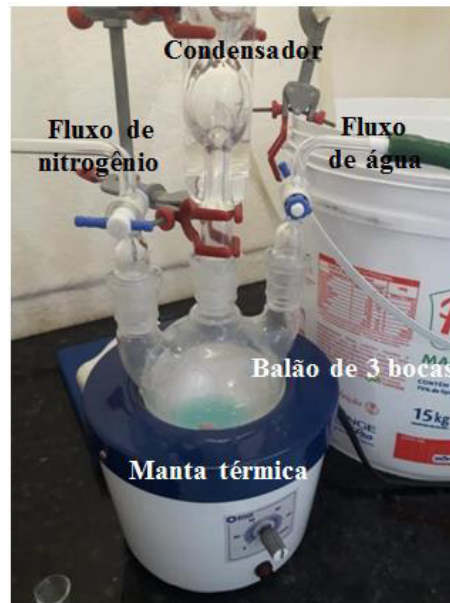
Figura 4: Esquema para o processo de decomposição térmica.
