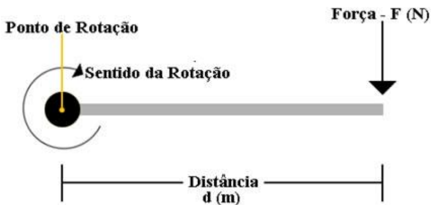
Figura 12 - Representação do Momento de Força
