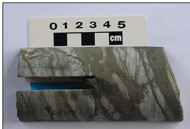
Figura. 6: Foto de testemunho de sondagem do furo 116/54,1 m (Corpo A), representando formações ferríferas bandadas do tipo óxido do Campo Taperebá.
