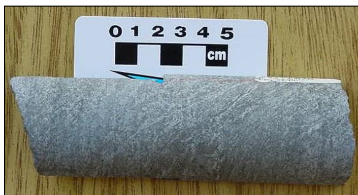
Figura 25: Foto de testemunho de sondagem do furo 186, Campo Taperebá B, referente aos xistos. Observar a marcante estruturação desenhada pelos planos de foliação.
