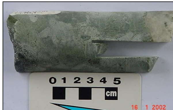
Figura 18: Foto de testemunho de sondagem, correspondendo a escarnitos do furo-186, Campo Taperebá B, coletado na profundidade de 47,8m.
