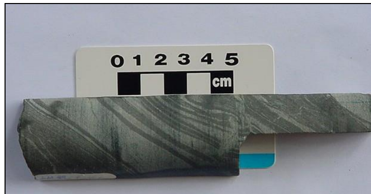
Figura 12: Foto de testemunho de sondagem do furo 186/114,9 m (Corpo B), representando formações ferríferas bandadas do tipo óxido-silicático do Campo Taperebá.
