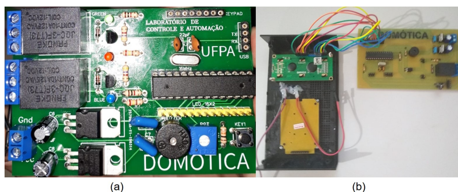
Figura 4 – (a) Placa da trava eletrônica instalada na bancada de automação residencial. (b) Placa da trava eletrônica instalada na porta do laboratório sede do projeto.
