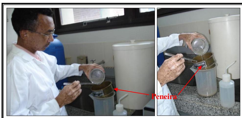
Figura 17 - Peneiramento a úmido utilizando a peneira com abertura de malha de 0,062 mm.
