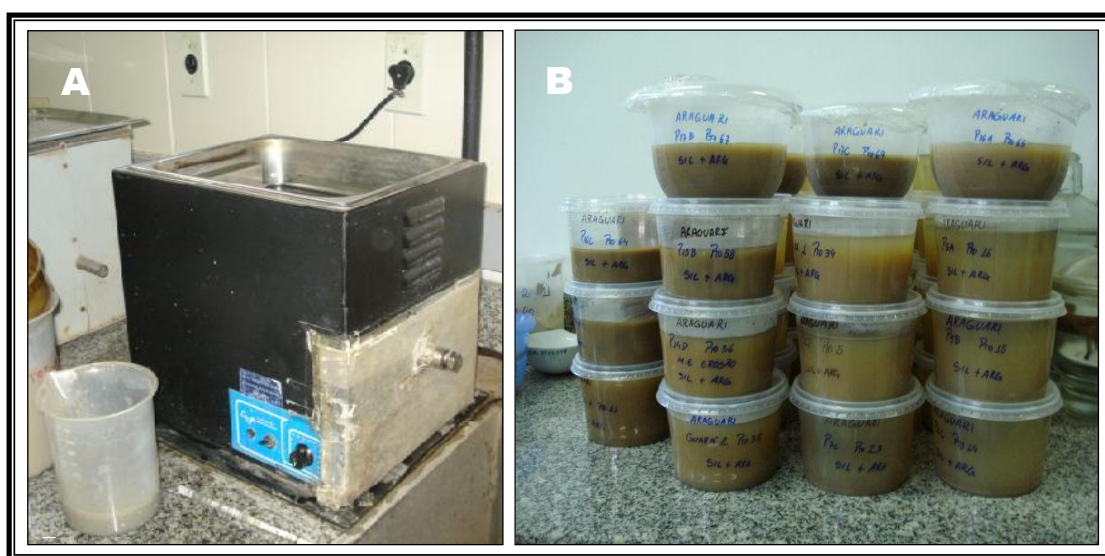
Figura 15 - A) Ultrassom; B) Amostra de sedimentos em decantação. Fotos do autor.
