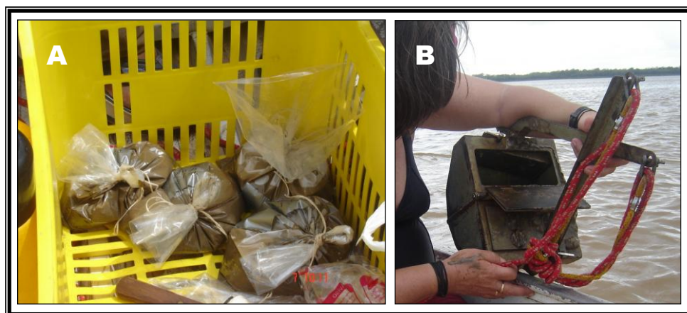
Figura 13 - A) Sedimento coletado; B) Amostrador do tipo Petersen . Fonte: Cedida pelo Laboratório Institucional de Oceanografia Geológica e Geofísica Marinha – LIOG.
