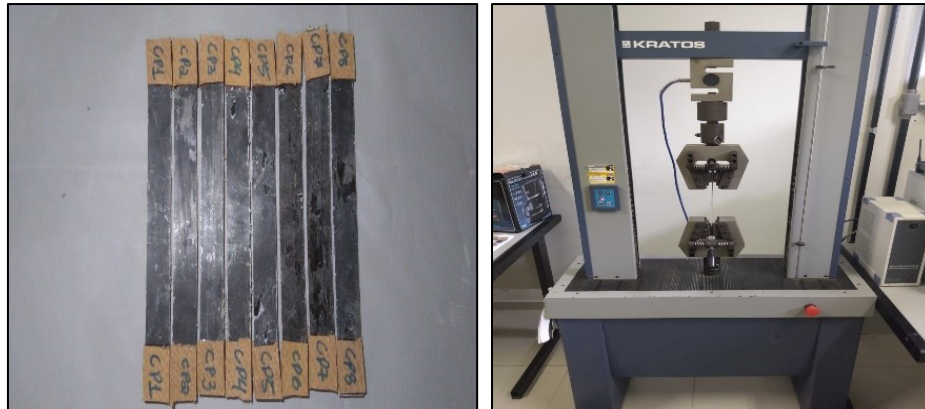
Figura 20 – (a) Corpo de prova-tab e (b) ensaio de tração
