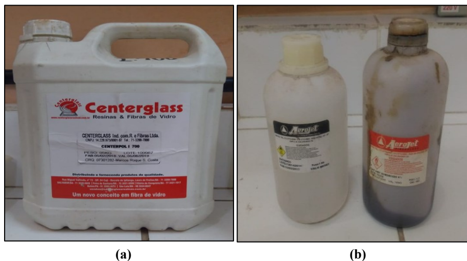
Figura 7 – (a) Resina poliéster insaturada isoftálica e (b) iniciador mek-p e acelerador de cobalto
