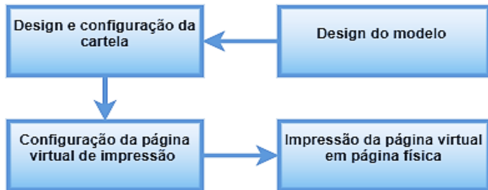
Figura 8. Fluxograma da parte computadorizada do processo de fabricação de NFC's.
