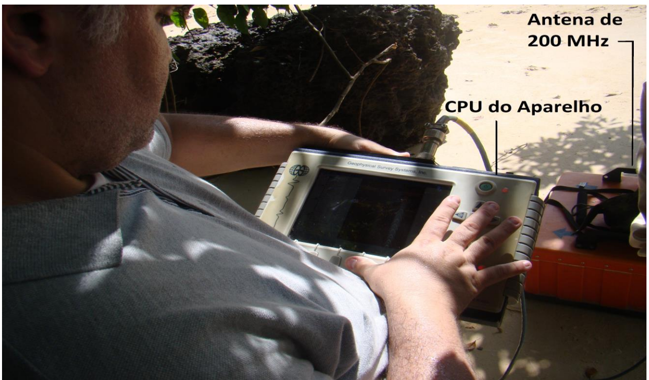
Figura 2 – Radar utilizado para o levantamento.
