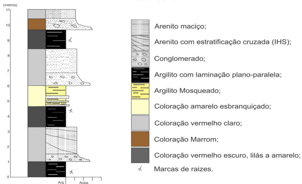
Figura 6 – Perfil litoestratigráfico da falésia da praia Brasília indicando granodecrescência ascendente.
