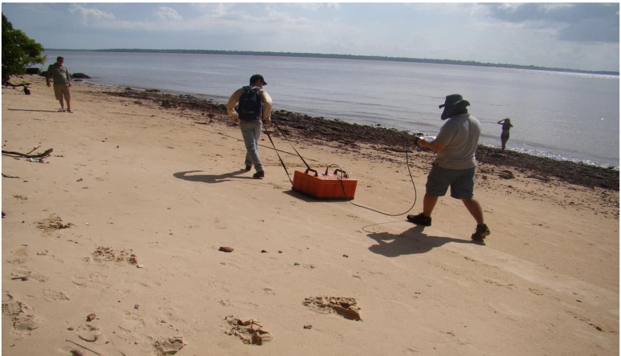
Figura 4 – Levantamento dos perfis de GPR na praia Brasília, ilha do Outeiro.
