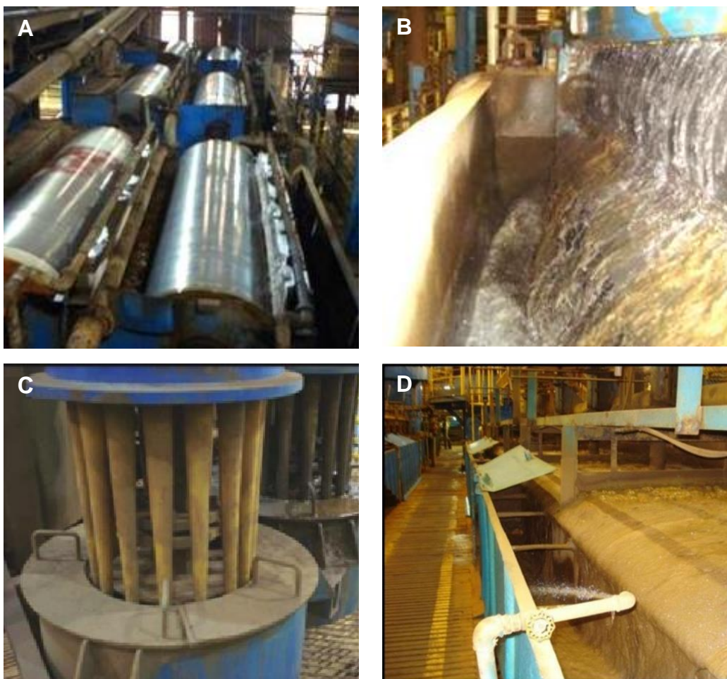
Figura 16- Unidade de concentração: (A) Separadores magnéticos; (B) Saída da Magnetita; (C) etapa de Deslamagem; (D) Etapa de Flotação.
