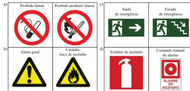
Figura 18 – Exemplos de sinalização de emergência básica: a) de proibição; b) de alerta; c) de orientação e salvamento; d) de equipamento e alarme.
