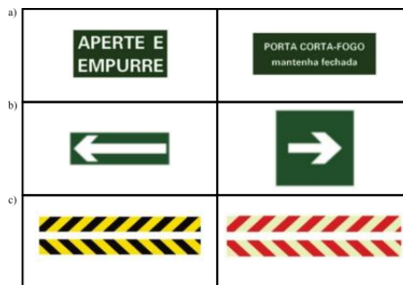
Figura 19 – Exemplos de sinalização de emergência complementar: a) mensagens escritas; b) setas indicativas; c) indicação de obstáculo.
