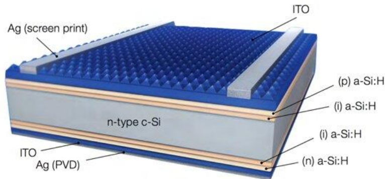
Figura 13 - Células com tecnologia HJT .
