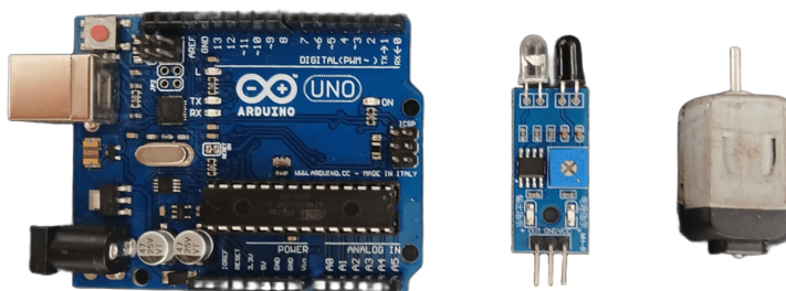
Figura 12 – Arduino Uno, sensor infravermelho e motor.
