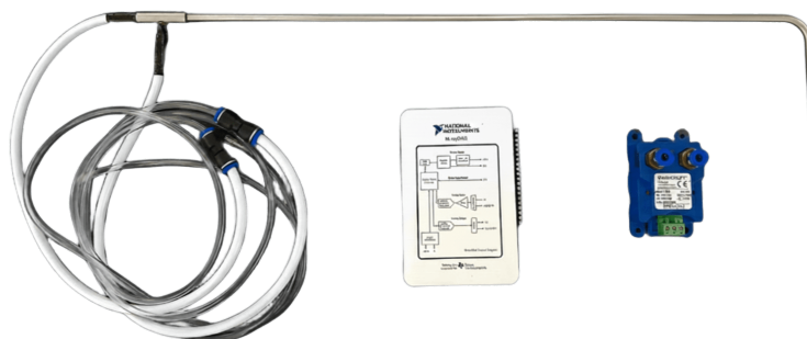
Figura 11 – Tubo de Pitot, placa de aquisição de dados e transdutor de pressão.
