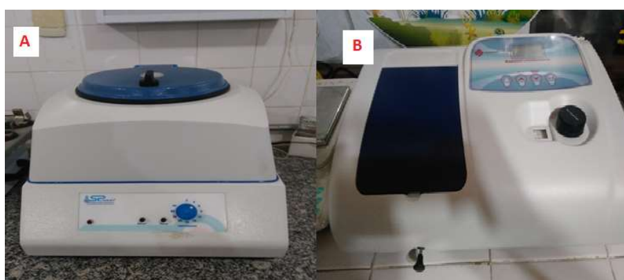
Figura 8- Equipamentos usados em laboratório (A- Centrifuga utilizado para homogeneização das amostras; B- Espectrofotômetro usado para medir absorbâncias dos extratos).
