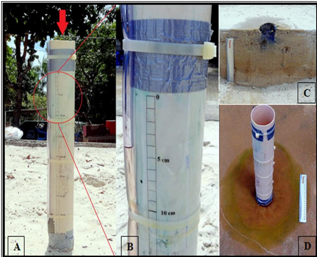
Figura 11: A) Permeâmetro artesanal; B) Intervalo de 10 cm que o fluido percorreu; C) Penetração e bulbo formado no perfil transversal; e D) Bulbo superficial no sedimento saturado.
