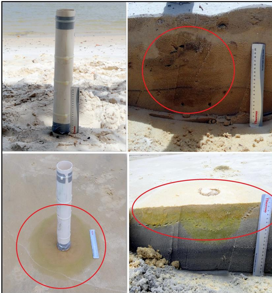
Figura 18: Bulbo formado pelo processo de infiltração de gasolina nos sedimentos com menor e maior teor de umidade.
