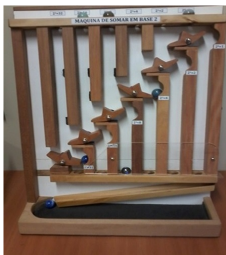
Figura 1.4: Máquina de Somar em Base 2. Fonte: BOM, c2014.
