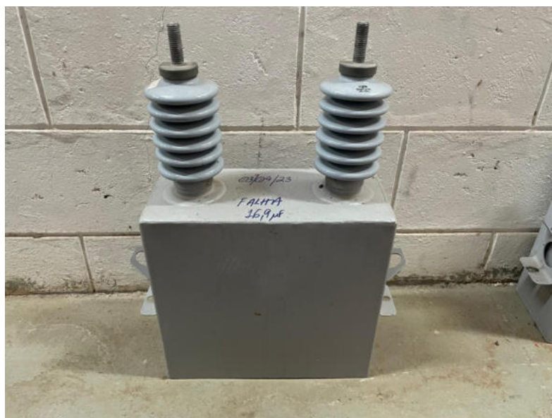
Figura 28 – Célula capacitiva utilizada no banco de capacitores em média tensão.
