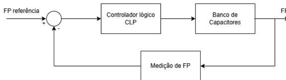
Figura 56 – Diagrama de blocos do sistema de controle automático do fator de potência
