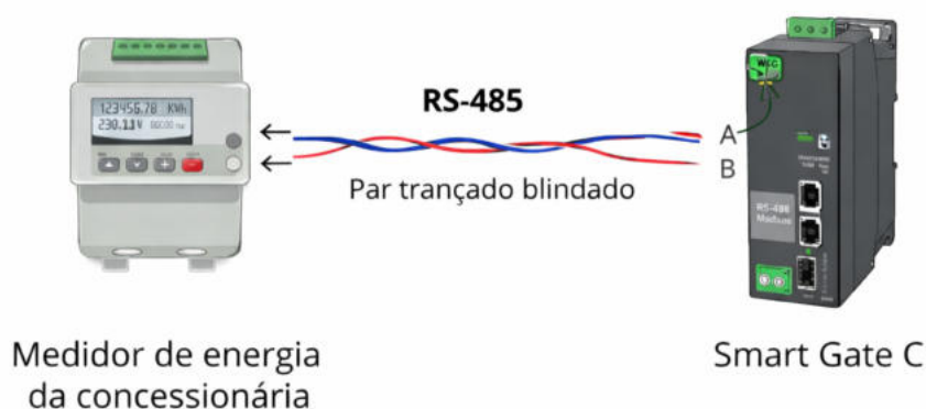
Figura 10 – Representação conceitual da comunicação RS-485 entre dispositivos de medição e aquisição de dados.
