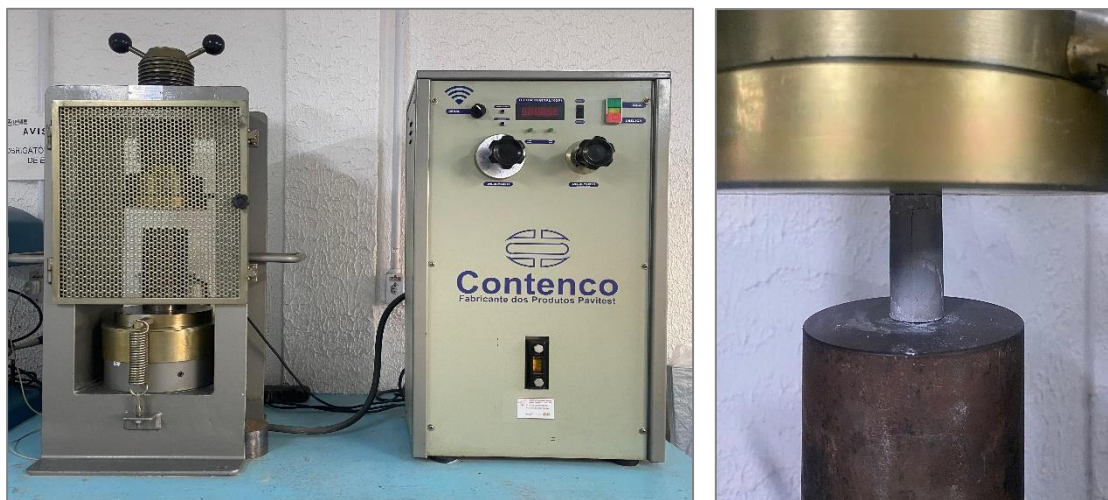
Figura 16 — (a) Prensa Hidráulica elétrica; (b) disposição do CP na prensa.
