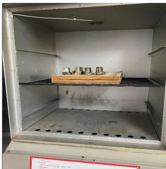
Figura 15 — CP's moldados curando em estufa.
