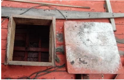
Figura 4: boca de urna de um barco.
