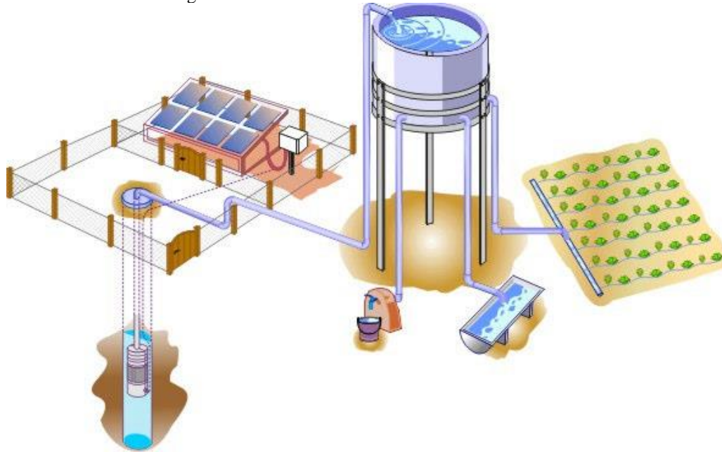
Figura 14 – Sistemas de bombeamento fotovoltaico.
