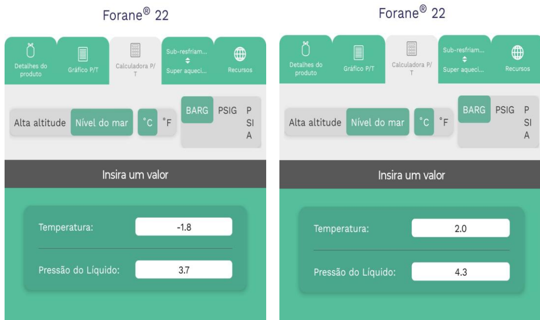
Figura 29 – Face do aplicativo Forane Refrigerants exibindo os valores de pressão a partir da temperatura
