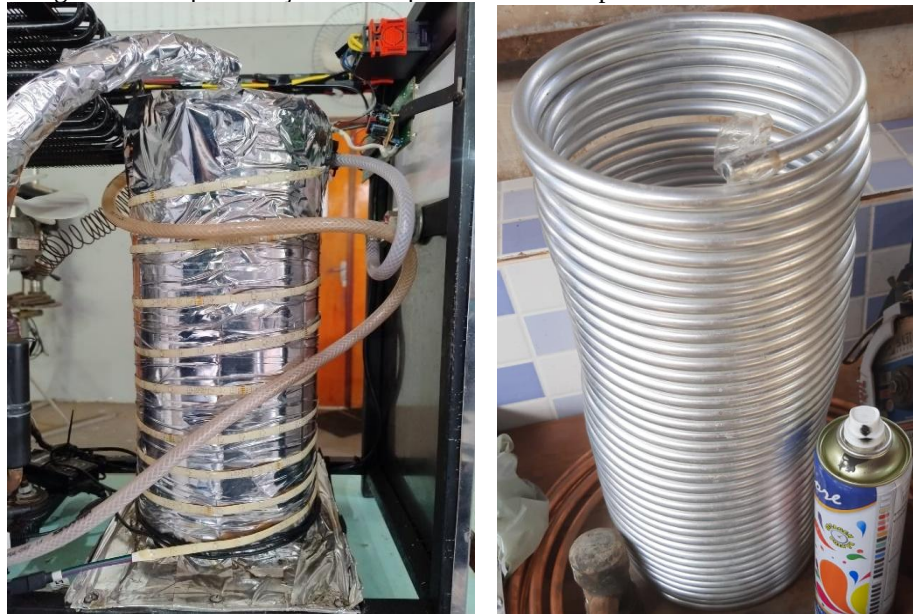
Figura 26 - Representação do compartimento de serpentinas totalmente isolado
