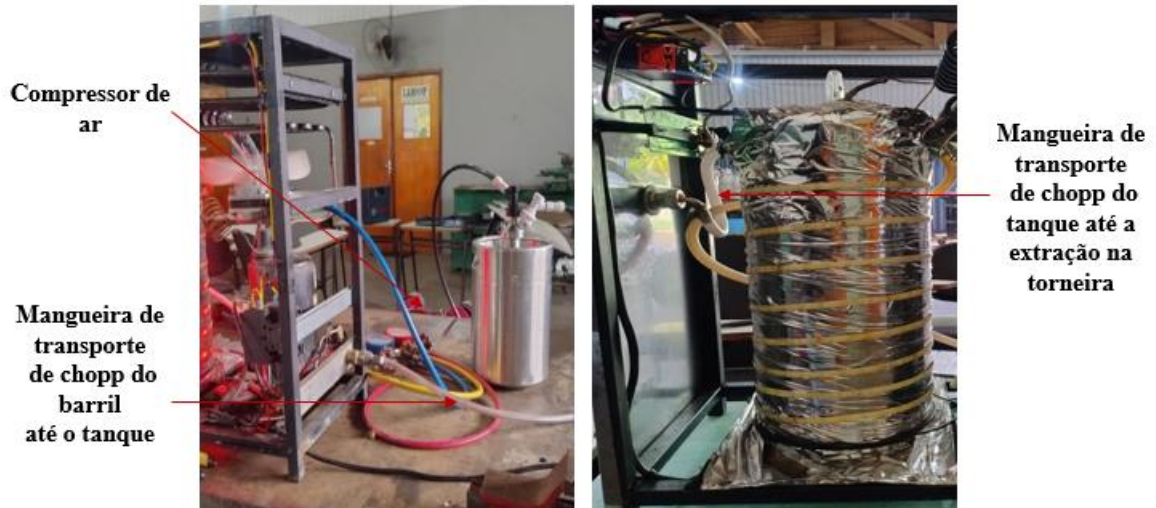
Figura 33 - Apresentação esquemática do momento do teste de vazão
