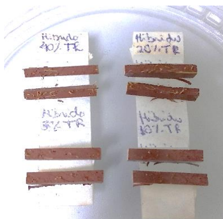
Figura 3.12- Corpos de prova para o MEV.
