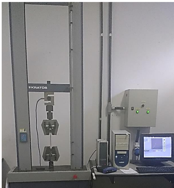
Figura 3.11 - Máquina universal de tração.
