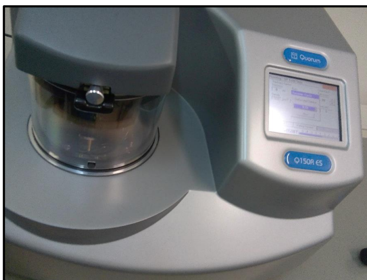
Fotografia 37 - Equipamento utilizado para a metalização das amostras, durante a preparação das mesmas para o ensaio com MEV e EDS.
