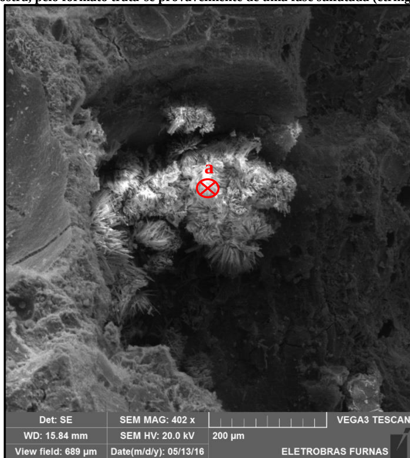
Micrografia 10 - Amostra 03 (Fundo): vista aproximada de um produto da pasta na superfície da amostra, pelo formato trata-se provavelmente de uma fase sulfatada (etringita).
