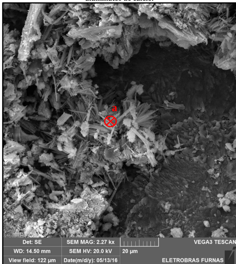
Micrografia 4 - Amostra 05 (Topo): visão da superfície da amostra, demonstrando possíveis sílico-aluminatos de cálcio.
