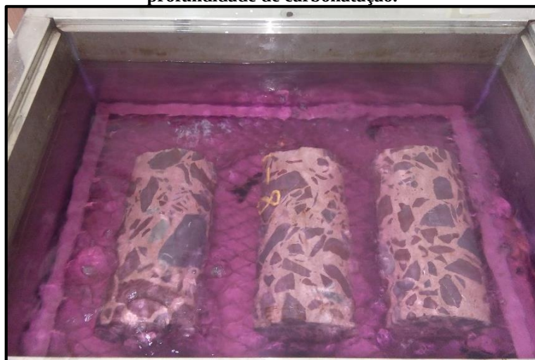
Fotografia 34 - Testemunhos sendo submetidos à fervura para ensaio de absorção. A água se encontra rosada devido a solução de fenolftaleína borrifada nos corpos-de-prova durante a verificação da profundidade de carbonatação.
