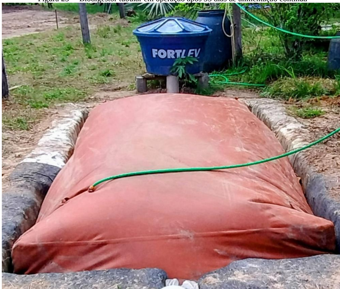
Figura 23 – Biodigestor tubular em operação após 35 dias de alimentação contínua
