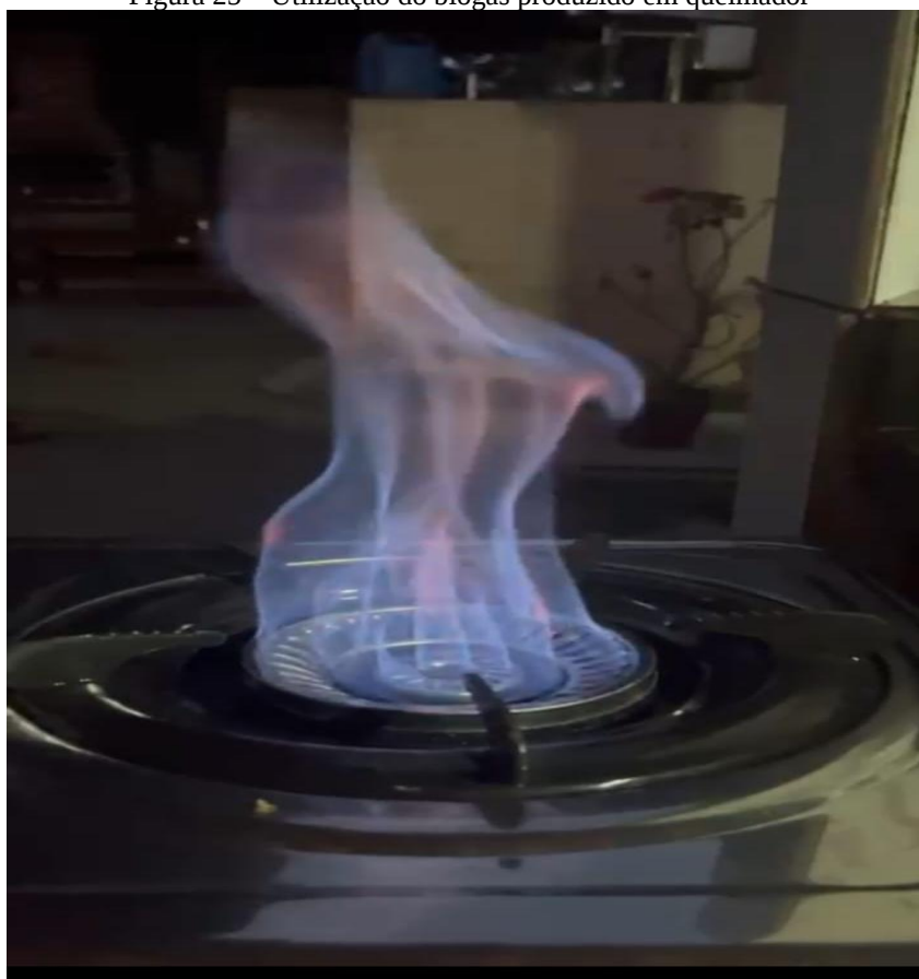
Figura 25 – Utilização do biogás produzido em queimador
