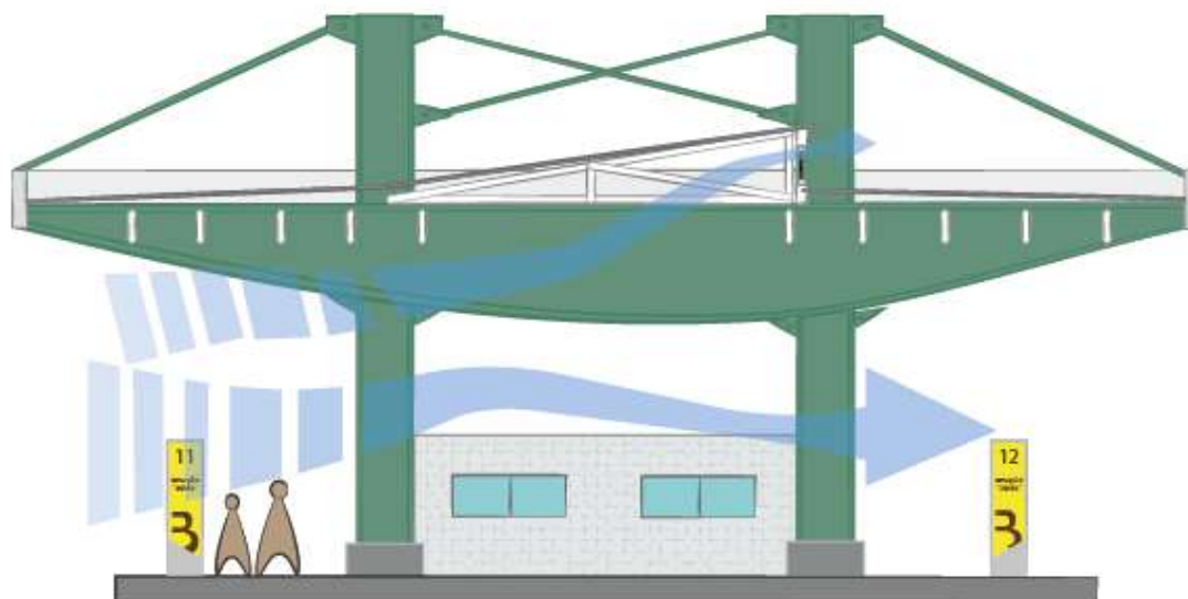
Imagem 46 - Ilustração do corte do terminal lado B com a nova ventilação
