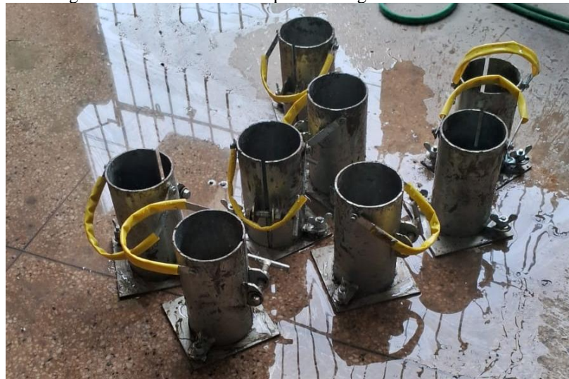
Figura 15: Formas utilizadas para moldagem dos CPs.
