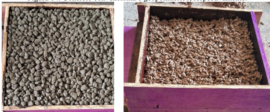
Figura 14: Concreto convencional e geopolimérico, respectivamente.
