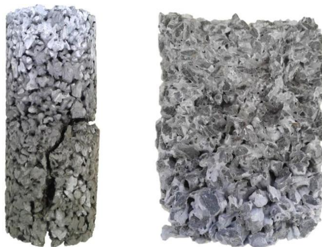
Figura 8: Ruptura à tração indireta e seção de fratura de concreto com duas camadas de compactação.
