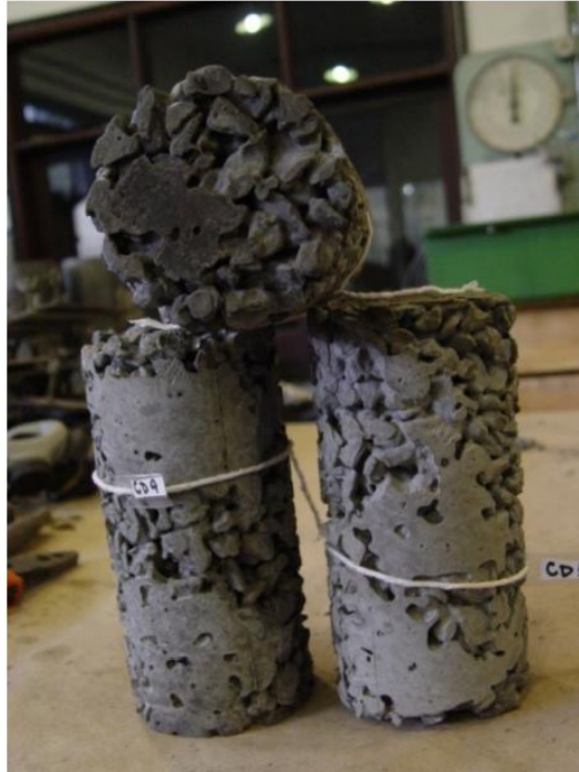
Figura 7: CPs do traço com relação a/c de 0,45, com poros obstruídos.
