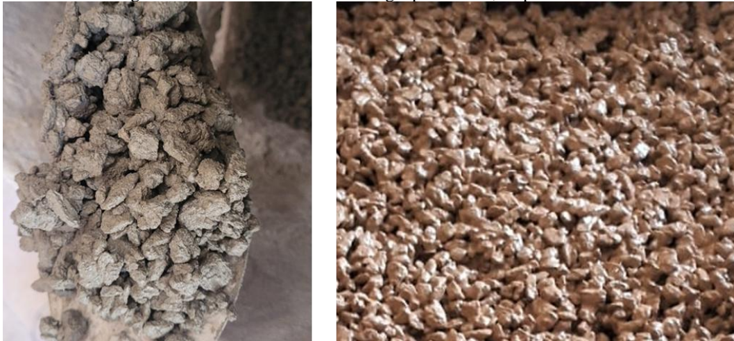
Figura 13: Concreto convencional e geopolimérico, respectivamente.
