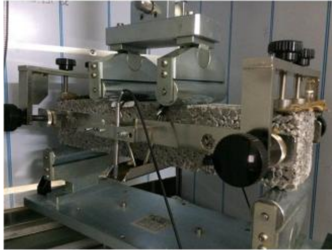
Figura 3: Ensaio de flexão em prisma de PC.
