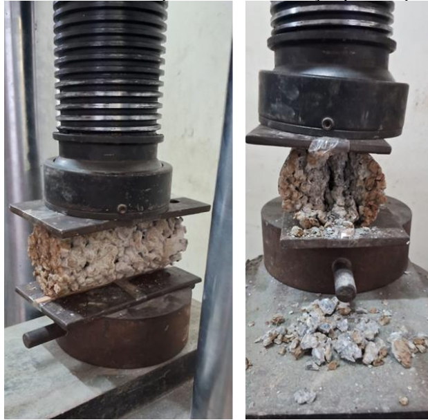
Figura 17: CPs antes e depois do ensaio de tração por compressão.
