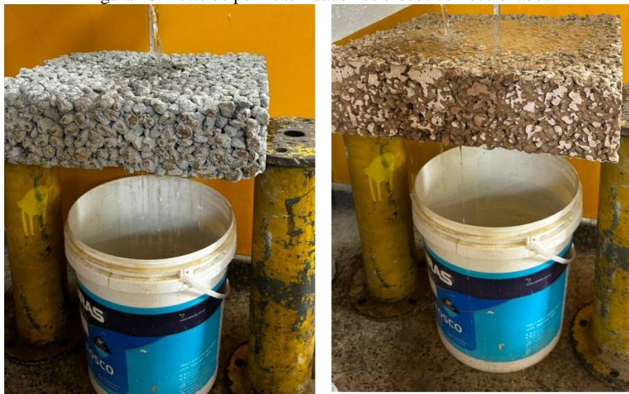
Figura 18: Teste de permeabilidade nos blocos confeccionados.
