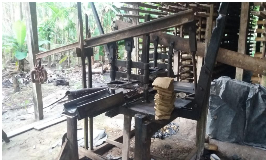
Prensa usada na fabricação manual de telha. (fonte: O AUTOR)
