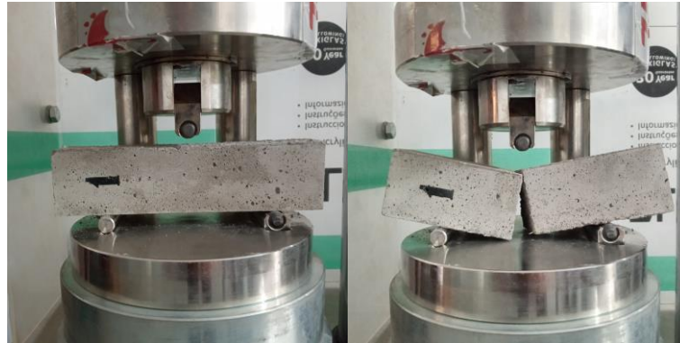
Figura 22 - Ensaio para determinação da resistência à flexão: a) corpo de prova posicionado na prensa e b) corpo de prova após a ruptura
