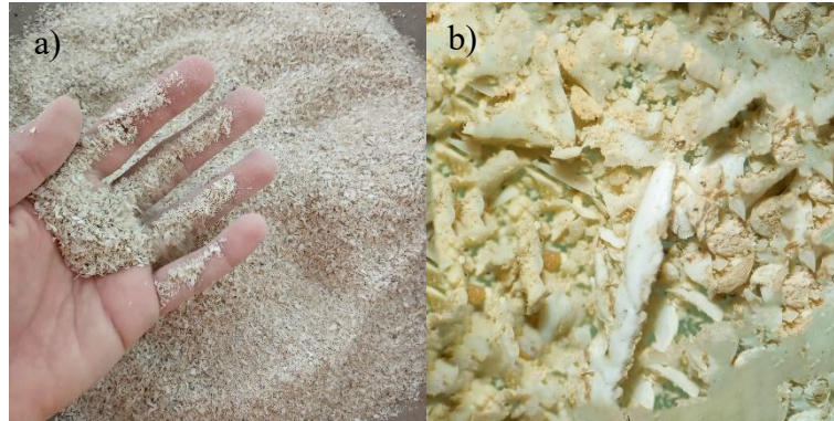
Figura 7 - Resíduo de polipropileno triturado: a) Demonstração macroscópica b) Demonstração microscópica com ampliação de 40 vezes
