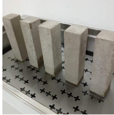
Figura 30 - Corpos de prova prismáticos colocados sob a coluna de água
