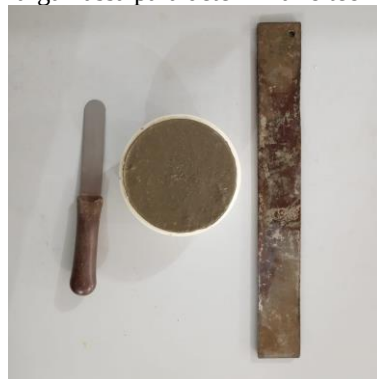
Figura 21 - Recipiente preenchido com argamassa para determinar o teor de ar incorporado
