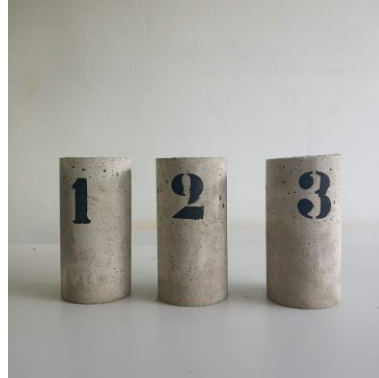
Figura 27 - Corpos de prova cilíndricos utilizados para determinação do módulo de elasticidade
