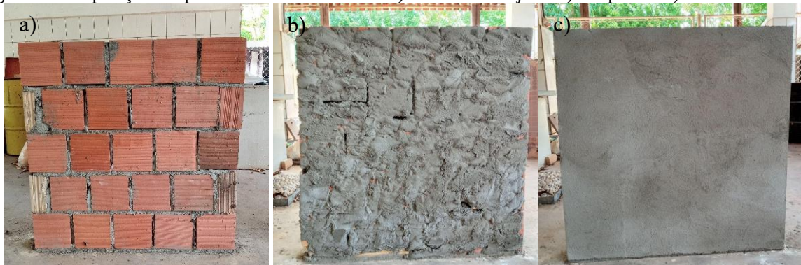
Figura 25 - Preparação das paredes a serem ensaiadas: a) Substrato de tijolos b) Chapisco e c) Reboco
