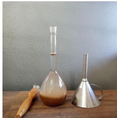
Figura 15 - Ensaio para determinação da densidade da areia com balão volumétrico
