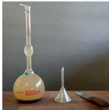
Figura 16 - Ensaio para determinação da densidade do PP com frasco de Le Chatelier
