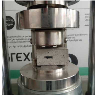
Figura 23 - Corpo de prova centralizado na prensa para determinação da resistência à compressão axial
