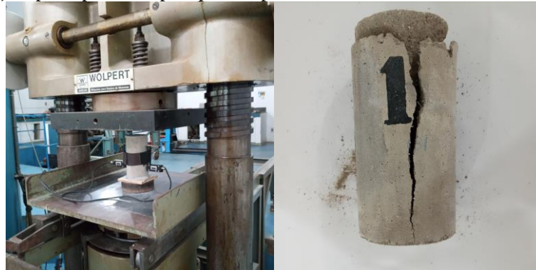
Figura 28 - Ensaio para determinação do módulo de elasticidade: a) Aplicação do método de carregamento e descarregamento e b) corpo de prova rompido por compressão axial
