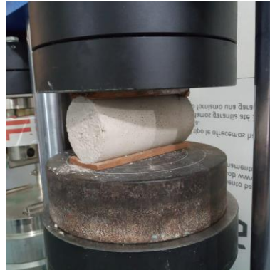
Figura 24 - Corpo de prova centralizado na prensa para determinação da resistência à tração por compressão diametral
