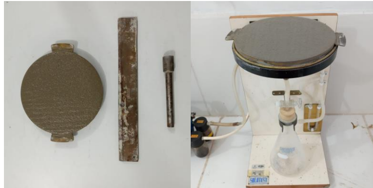
Figura 20 - Ensaio de para determinação da retenção de água: a) Disco com argamassa após rasamento e b) argamassa submetida ao vácuo no funil de Buchner
