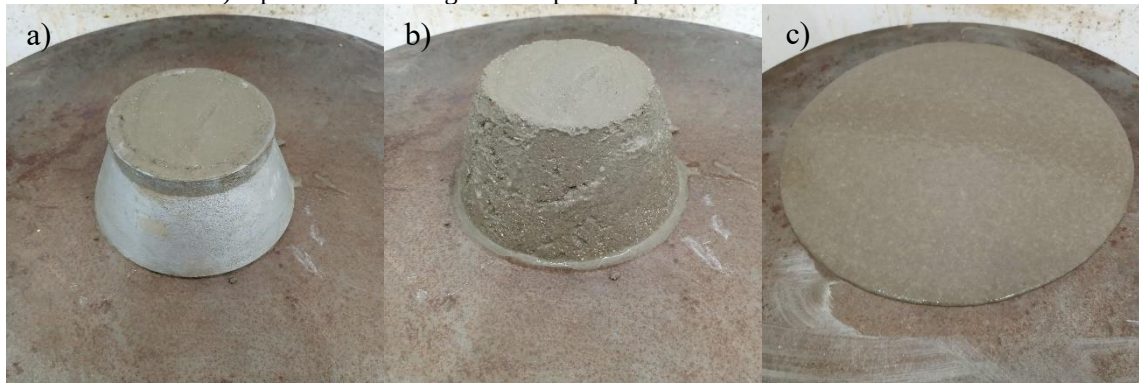
Figura 18 - Ensaio para determinação da consistência: a) argamassa no molde após a compactação das camadas b) retirada do molde e c) espalhamento da argamassa após as quedas da mesa de consistência
