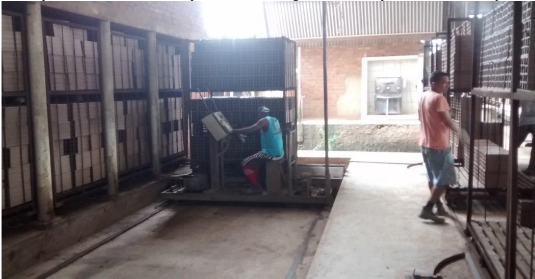
Figura 25: Maquinário Moderno De Transporte Chamado Vagonete, Com Capacidade Para 300 Tijolos
