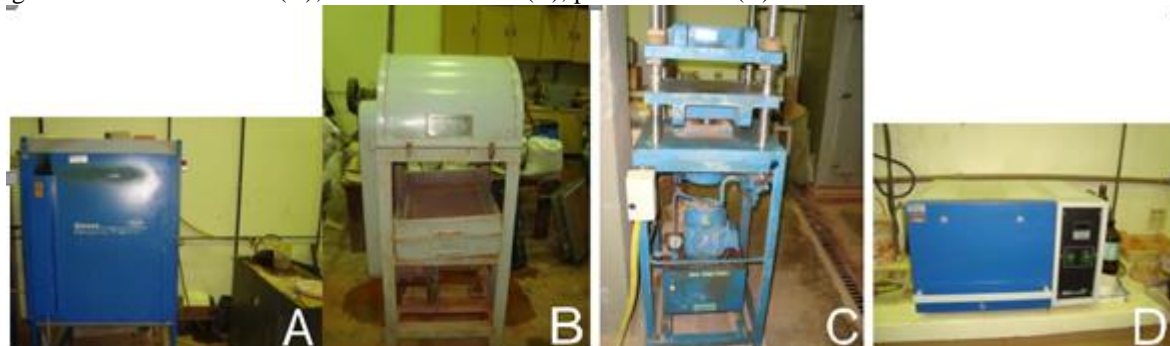
Figura 21: Forno de 110°C(A); Moinhos de bolas (B), prensa elétrica (C) e forno de 1000°C
