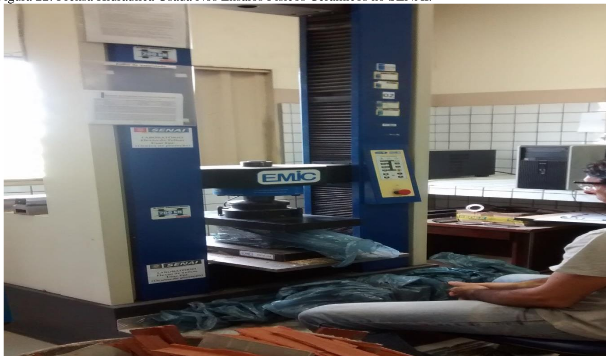
Figura 22: Prensa Hidráulica Usada Nos Ensaio Físicos Cerâmicos no SENAI.
