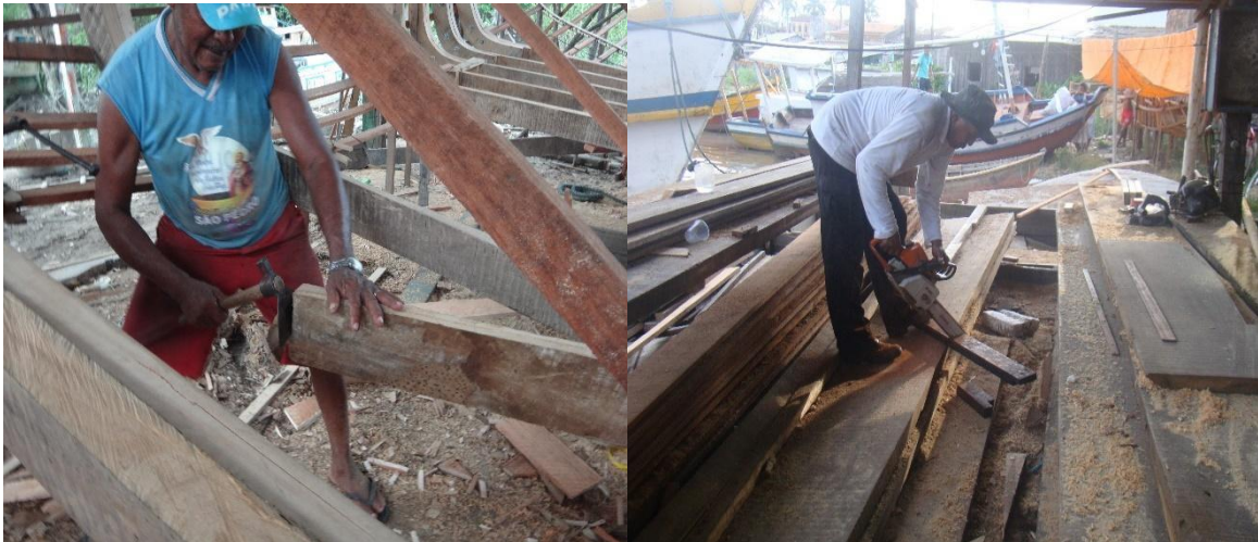
Figura 05: Carpinteiro utilizando instrumento denominado enxó; Carpinteiro usando motosserra (Fonte: Joerbt Ribeiro, 2015).
