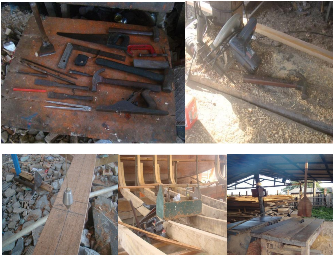
Figura 04: Ferramentas da carpintaria naval (Prumo de centro, serra de mesa, plaina elétrica, enxó, caixa de ferramenta, serrote, enxó, martelo, serra elétrica, esquadro, compasso, motosserra). Fonte: Joerbt Ribeiro, 2015
