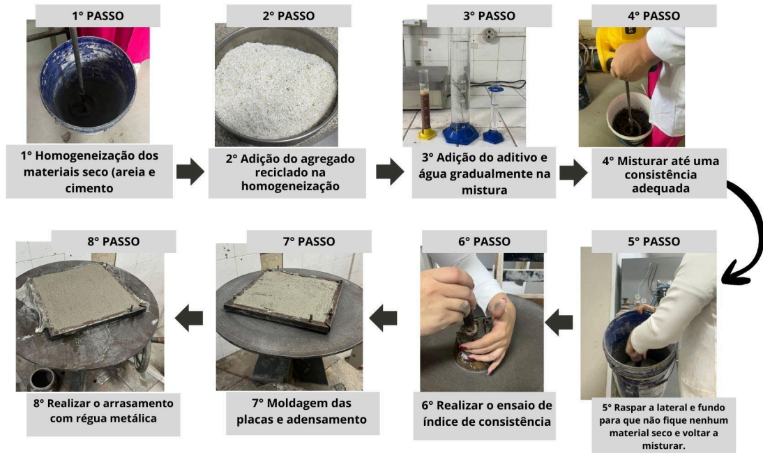
Figura 03: Processo de produção de placas cimentícias com resíduo polimérico.
